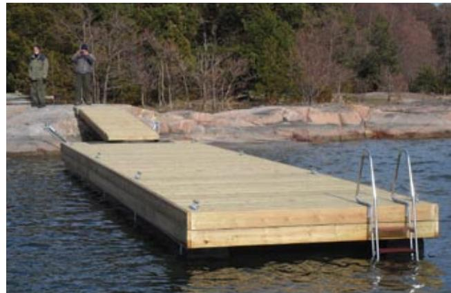
Pontonul Shellfish 2B este un ponton robust pe tuburi din plastic, echipat pentru acostarea ambarcatiunilor.
