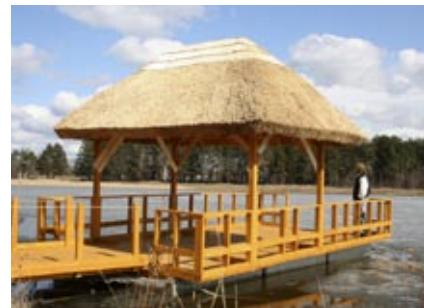
Acest mic foisor este montat pe trei flotoare din beton. Structuri plutitoare de tipul teraselor, foisoarelor, observatoarelor sau punctelor fixe de paza, sunt necesare ca structuri complementare locuintelor de la malul apei.
