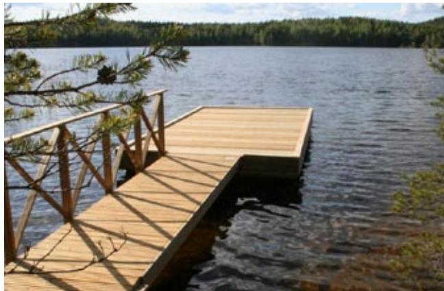
Pontonul Shellfish are bordul liber suficient de redus astfel incat poate fi folosit si ca platforma de imbaiere. Este disponibil la diferite lungimi si, contra cost, se poate echipa cu balustrade si pod de acces.
